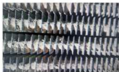
(某厂H型翅片管运行一年后积灰、掉片情况)
