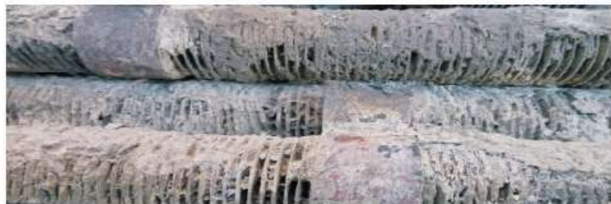
(某厂高频焊接螺旋翅片管运行两年后积灰情况)
