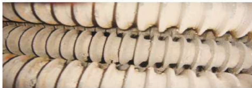
(某厂整体型螺旋翅片管运行七年后积灰情况)
