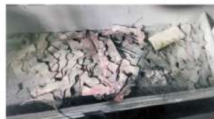
(某厂H型翅片管运行一年后积灰、掉片情况)
